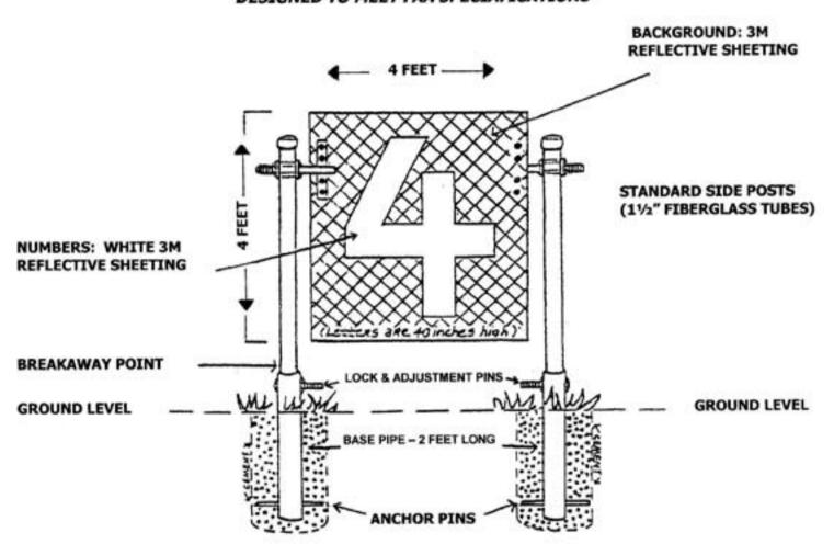
SPECIAL MOUNTING ALLOWS SIGN TO SWING UNDER HIGH WIND VELOCITY & JET BLASTS
